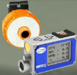
HIPSÓMETRO VERTEX 5 360° DE HAGLÖF
