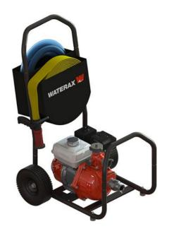
Las VERSAX-6 y VERSAX-9 de WATERAX son motobombas autocebantes de impulsores gemelos versátiles, robustas y económicas. Estas unidades tienen motores Honda de 6hp y 9hp. Producen presiones máximas de 120 PSI (8.3 bar) y 150 PSI (10.3 bar). También producen tasas de flujo de hasta 397 I/min (105 US gpm). Su diseño compacto las hace ideales para una variedad de aplicaciones como combate de incendios, llenado de tanques y transferencia de agua.
