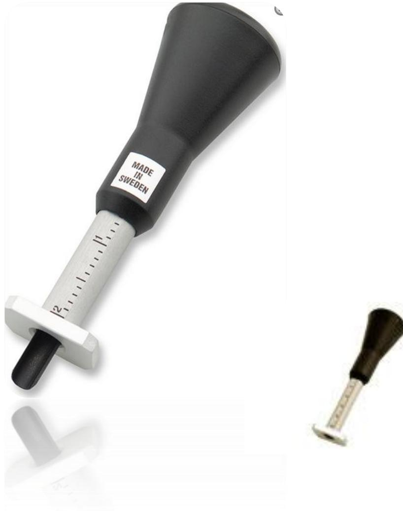
Use el medidor de corteza para determinar grosor en mm o 0.1". Graduación de 0-50 mm o 0" a 2". El filo de corte queda protegido por el mango cuando no se está usando. Acero sueco de alta calidad, mango de plástico. Art no 10-301-1003
