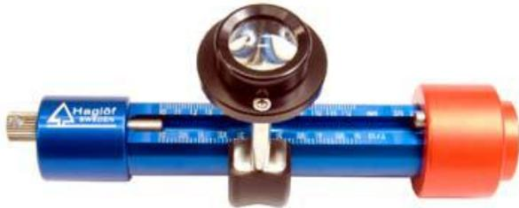
El lector de núcleos de árbol Haglöf permite examinar núcleos de madera de hasta 12cm/5" con diámetros de núcleo de hasta 5.15mm/0.200". El sistema óptico de alta calidad con lupa de aumento 6x provee una lectura y un examen precisos del núcleo.
