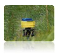
El Emisor T3 es usado junto con El Vertex, el Vertex Láser y el DME. Es resistente al agua, robusto y tiene una construcción simple en un color brillante y visible. Trabaja con una batería AA. Atore el emisor en el troco del árbol o use el adaptador puesto en el bastón para medir en sitios circulares. Diámetro 70mm. Peso: 85 g. 1 batería alcalina de 1.5V AA, consumo máx. 9mW.
