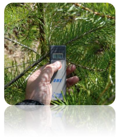
mínimo para ser incluido en el punto. La función le permite hacer un levantamiento con Prisma o relascopio en predios con maleza espesa, que normalmente no podría hacer usando un prisma o relascopio estándar.
