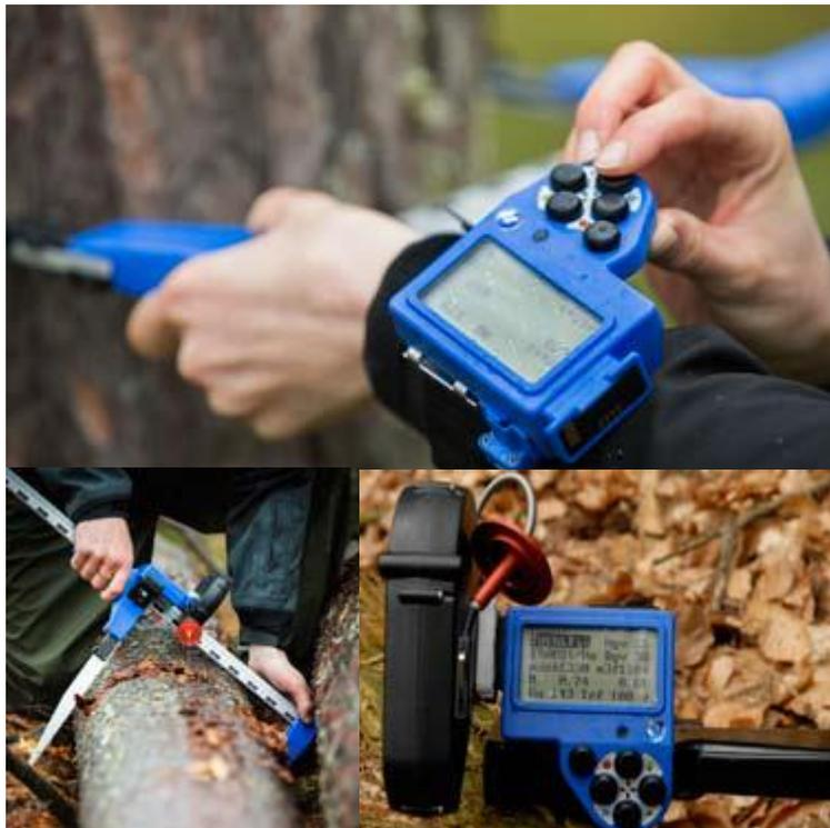
La DP II está adaptado para el dimensionado de troncos. Los brazos están diseñados para ser colocados fácilmente entre y debajo de los troncos y la madera apilada. El Smart Scale™ y la terminal de datos se pueden usar como instrumentos independientes (use la escala como forcípula manual eficiente y envíe los datos del diámetro inalámbricamente a la terminal que se encuentra en su bolsillo o muñeca).
