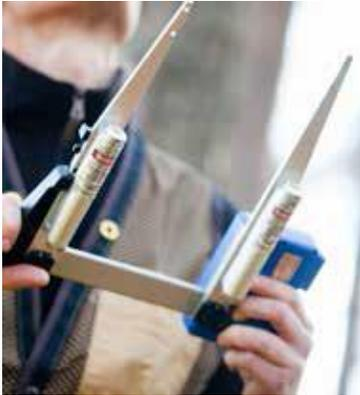
¡Mida diámetros y el diámetro del fuste superior desde lejos con su forcípula computarizada! Con una forcípula DP II equipada con Gator Eyes y software adaptado, se puede medir el diámetro, el ángulo y la altura de un objeto distante. Use los brazos de la forcípula para apuntar y medir y luego registrar el diámetro.
