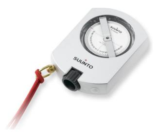
Los clinómetros Suunto pueden ser usados para medir alturas de árboles, torres, edificios, etc.; para medir pendientes para nivelación o topografía preliminar; y para medir ángulos verticales para instalaciones celulares y satelitales y más.
