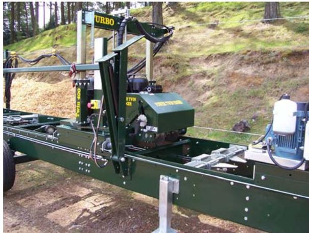
Un rotor de troncos hidráulico rota el tronco a la posición correcta. El láser indica en el extremo del árbol el lugar en el que el corte debe ser hecho.
