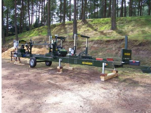
Con Ecosagen usted puede aserrar rápidamente troncos de un largo máximo de 6.2 metros y un diámetro máximo de 50 centímetros.
