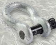
GRILLETES PCA-1279 – 13 mm (1/2") – Límite de carga de trabajo: 2 tons PCA-1277 – 16 mm (5/8") – Límite de carga de trabajo: 3-1/4 tons PCA-1278 – 20 mm (3/4") – Límite de carga de trabajo: 4-3/4 tons
