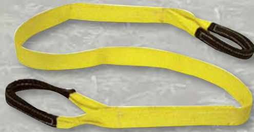
ESLINGAS DE POLIESTER 50 mm (2") de ancho – Capacidad en forma de U: 2903 kg (6400 lb) PCA-1258 – 3.1 m (10') PCA-1259 – 2.44 m (8') PCA-1260 – 1.83 m (6')
