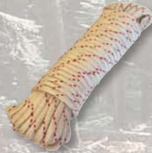
CUERDA DE POLIESTER DE TRENZADO DOBLE – 13 mm (1/2") MBS*: 3674 kg (8100 lb) PCA-1215 – 45.75 m (150') PCA-1213 – 91.5 m (300') PCA-1216 – 183 m (600') Otras longitudes disponibles en pedido especial
